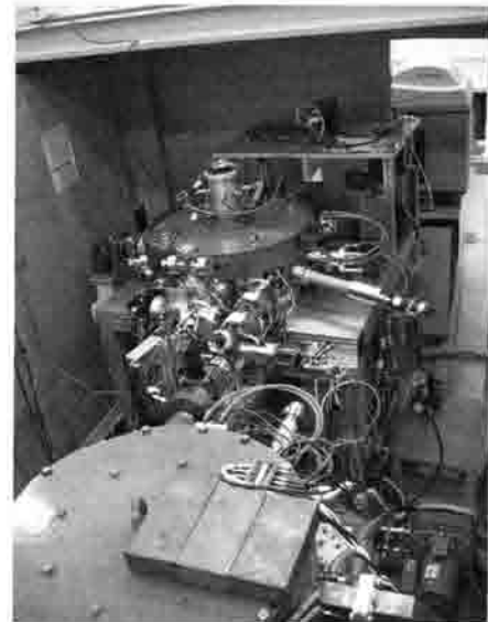
図 1 “みらくる 6X”高輝度 X 線発生システム。手前が 6 MeV マイクロトロン入射器。ピンクのボディが卓上型シンクロトロン。右に突き出したアームは、ターゲット駆動機構。リングの上にあるのは、磁気パルス圧縮装置。水色シールドの向こうに見えるのはたんばく質構造解析のためのイメージングプレート (IP) システム。シールドは開閉式で、X 線取り出し用窓がある。IP システムはレールに載っていて前後できる。別の計測器を置くこともできる。
